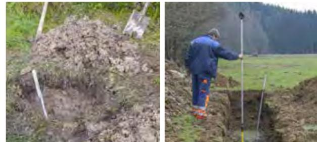
In den vorhandenen Altläufen kann man die Kieselsohle im Bereich der Furten aufgraben und einmessen. Fehlen naturnahe Laufstrukturen, so erbringen Schürfe immerhin gute Daten über die Mächtigkeit der Auelehmschicht und die Höhenlage der Talkiese.
