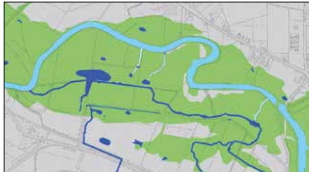
Entscheidend für den Erfolg: Entwässerungsgräben wurden verschlossen und die seitlichen Zuflüsse Disselbach und Geistbach wieder in die Aue geleitet. Oben die Situation vor, unten nach den Maßnahmen, die im Jahr 2005 durchgeführt wurden.
