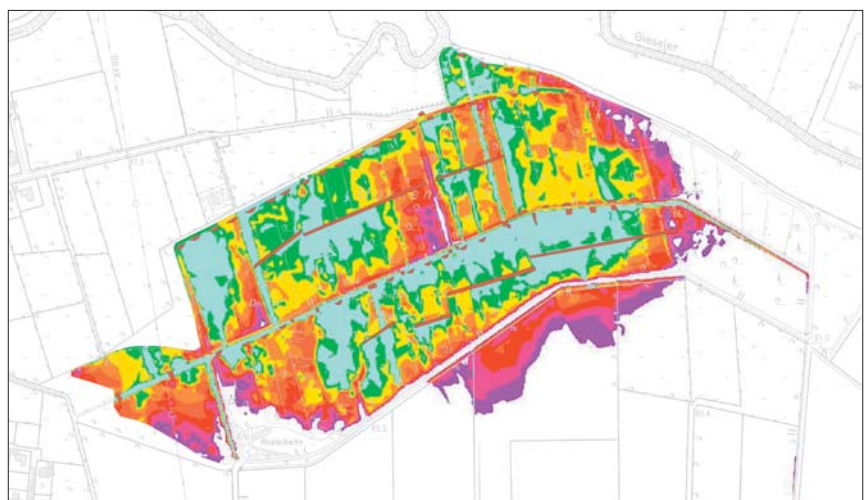
Beispiel eines digitalen Gelände Modells (DGM) erstellt mit Gecko GeoDataCore. Das Farbspektrum weist auf das Wiedervernässungspotential der Flächen hin. Die blauen und grünen Bereiche können gut vernässt werden. Flächen mit den Farbtönen gelb bis violett weisen auf eingeschränkte Wiedervernässungsmöglichkeiten hin.
