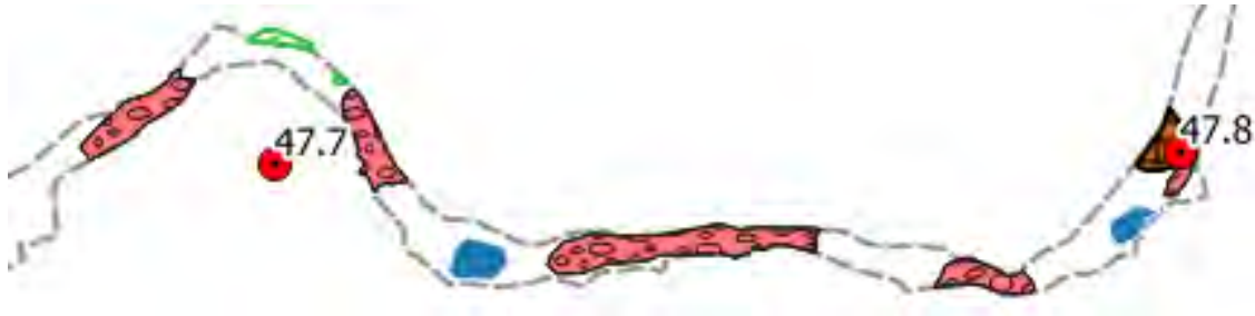
Abb. 5.4-81: Ausschnitt der Kieskartierung oberhalb Aalbecke, km 47,7. Legende: Kiesbänke: rosa; Kolke: blau, Totholz: braun, Vegetation: grün
