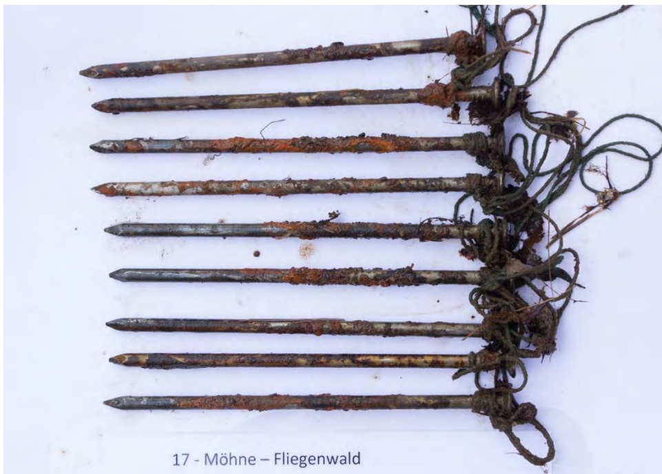
Abb. 5.5.2-6: Probestrecke 17, Möhne Fliegenwald: Ein Nagel fehlt, wahrscheinlich der letzte, nicht in den Kies eingeschlagene „Referenznagel“.
