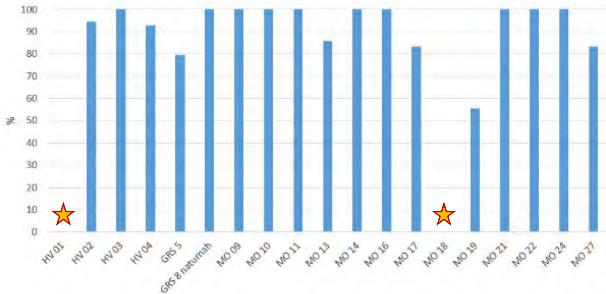
Abb. 5.1.1-2: Erkennungsrate von bei der Bodenkontrolle festgestellten Rauschen bei der Drohnenkartierung
