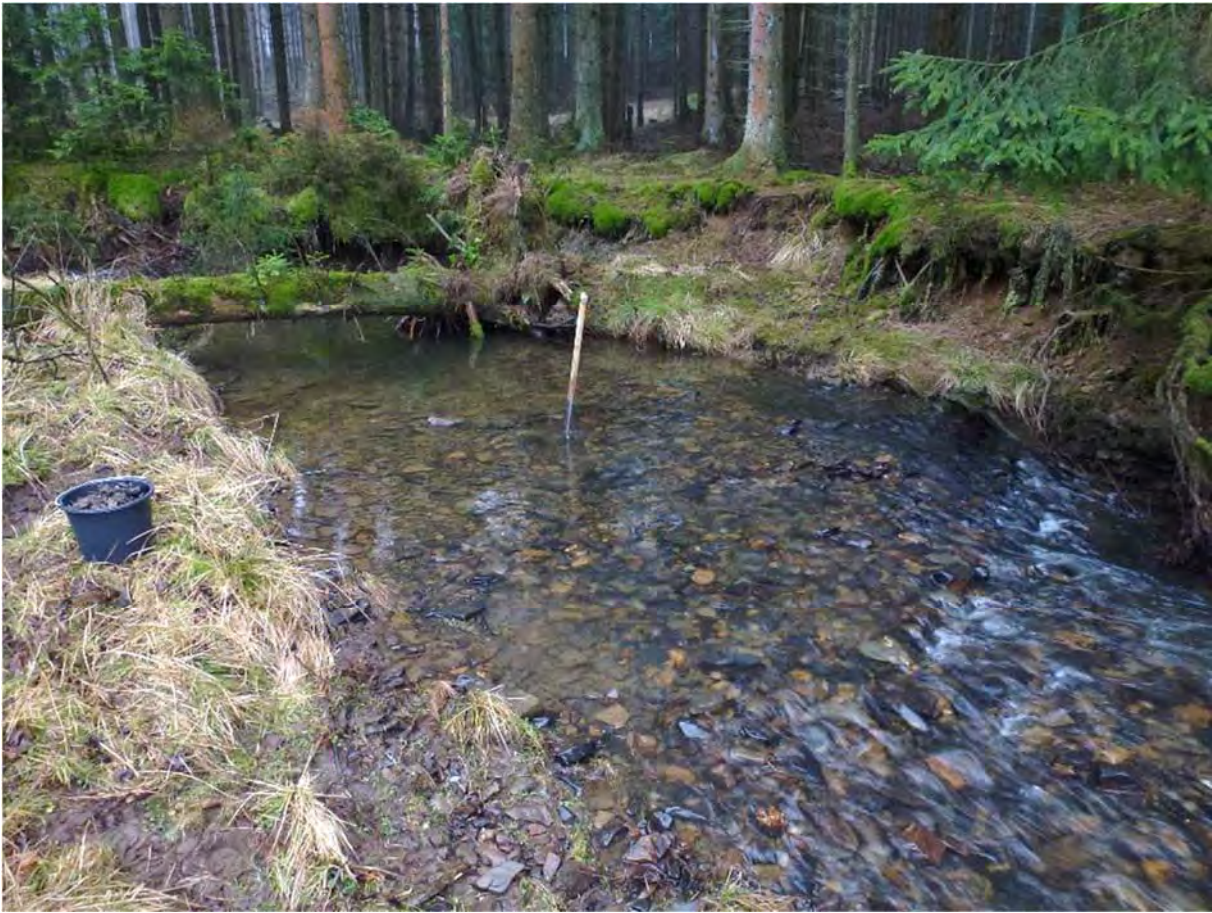
Abb. 4.3.1.1-1: Probenahme aus dem Kieskörper der Großen Schmalenau für die Sieblinien-Analyse
