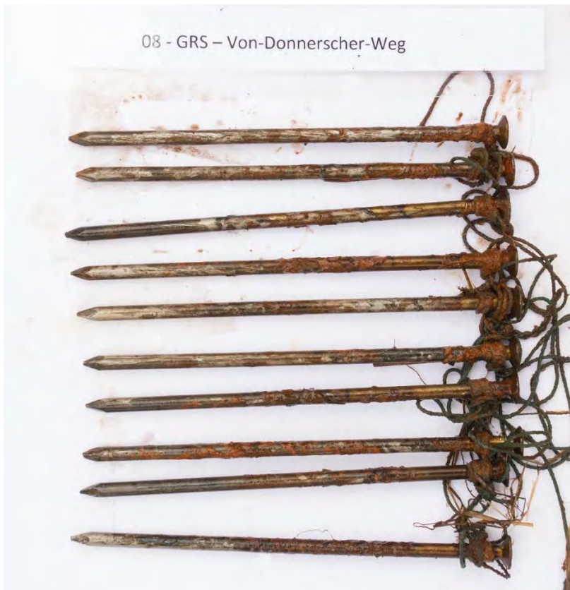
Abb. 5.5.2-5: Probestrecke 8, Große Schmalenau am Donnerschen Weg: Der unterste Nagel ist die „Referenz“. Er zeigt deutlichen Rostansatz, aber auch die anderen Nägel sind erheblich verrostet.
