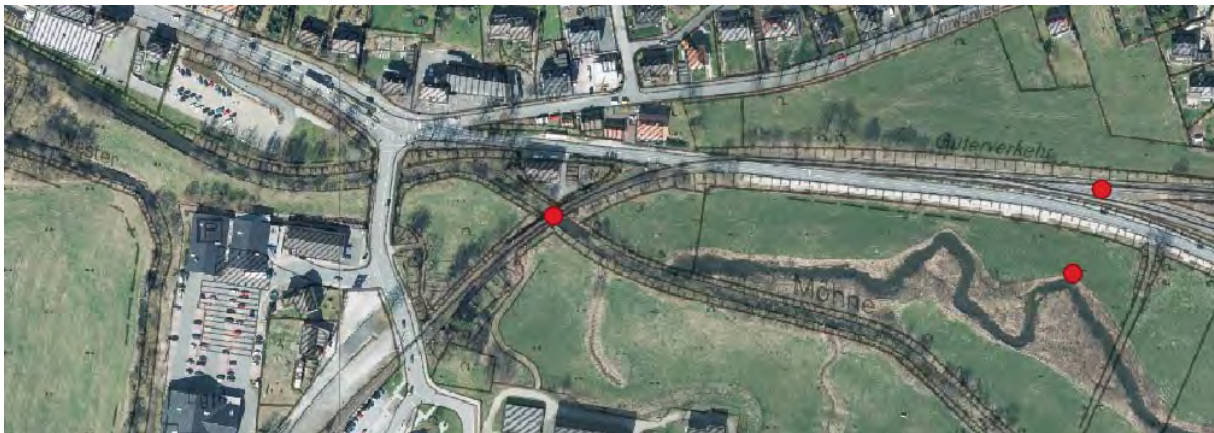
Abb. 4.1-8: Beispiel für Referenzpunkte im Luftbild zur Geo-Referenzierung der Drohnenbilder (Quelle: Geobasis NRW-WMS NW DOP, Abrufdatum Nov. 2020)
