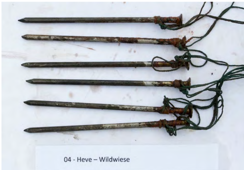
Abb. 5.5.2-3: Probestrecke 4, Heve an der Wildwiese: Vier Nägel fehlen, darunter auch der an der Oberfläche der Kiesbank platzierte „Referenznagel“.
