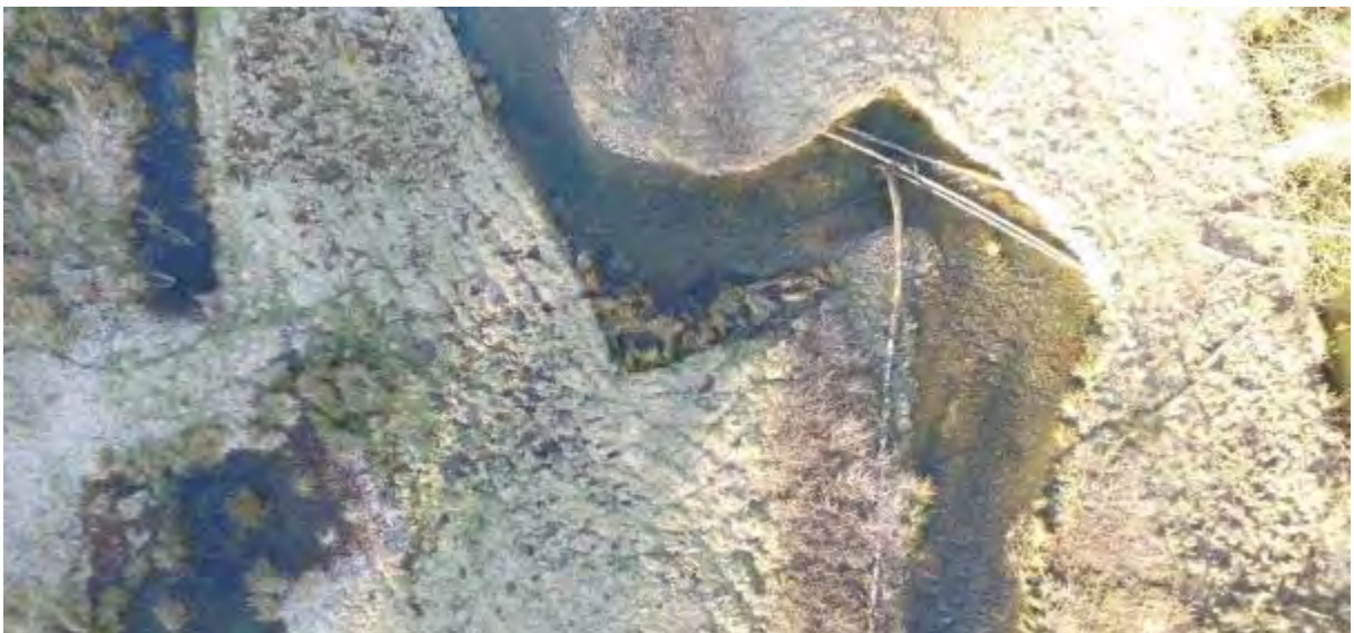
Abb. 5.4-19: Renaturierungsabschnitt der Großen Schmalenau bei Neuhaus fünf Jahre nach Herstellung. Die Strömung kürzt hier in der Innenkurve am eigentlichen Gleitufer ab und im Außenbereich haben sich in den abgelagerten Feinsedimenten bereits Binsen angesiedelt.
