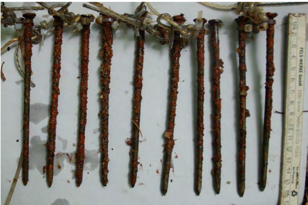
Abb. 4.3.2.2-2: Diese nach drei Monaten im Gewässer rostverkrusteten Nägel lassen auf eine gute Sauerstoff-Versorgung im Interstitial schließen (aus Land Oberösterreich 2005).
