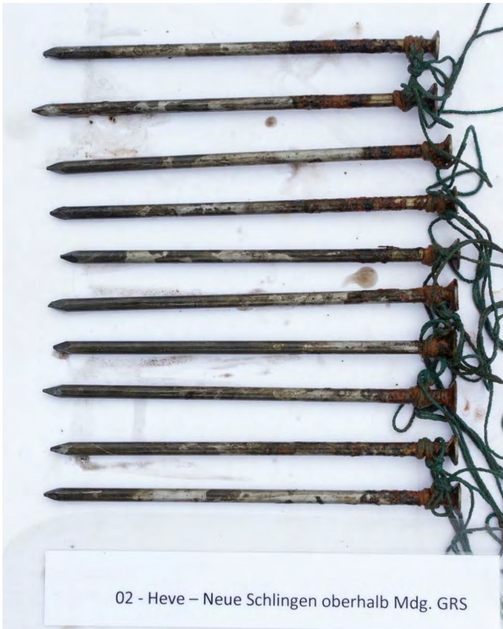
Abb. 5.5.2-2: Probestrecke 2, Heve oberhalb der Mündung der Großen Schmalenau: Der theoretisch besonders stark verrostete, nur unter einem Stein im Wasser platzierte „Referenznagel“ könnte der zweite von unten sein. Da er nicht eindeutig von den anderen Nägeln zu unterscheiden ist, scheint die Sauerstoff-Versorgung hier selbst unter einem Stein an der Oberfläche der Kiesbank nicht gut zu sein.
