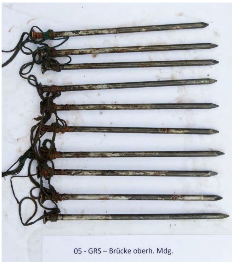
Abb. 5.5.2-4: Probestrecke 5, Große Schmalenau oberhalb der Mündung: Hier ist der „Referenznagel“ nicht von den anderen zu unterscheiden, was auf eine schlechte Sauerstoff-Versorgung selbst an der Oberfläche der Kiesbank hindeutet.
