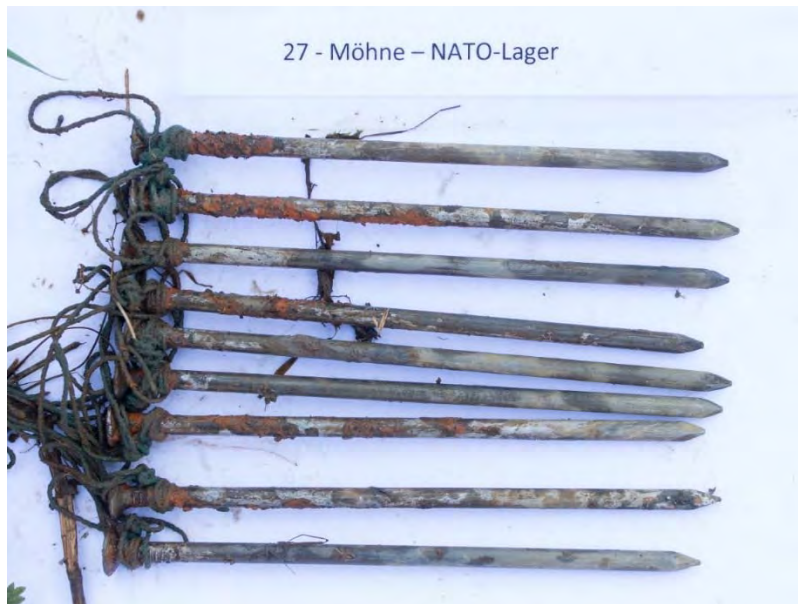
Abb. 5.5.2-9: Probestrecke 27, Möhne NATO-Lager: Ein Nagel fehlt, wahrscheinlich der letzte, nicht in den Kies eingeschlagene „Referenznagel“.
