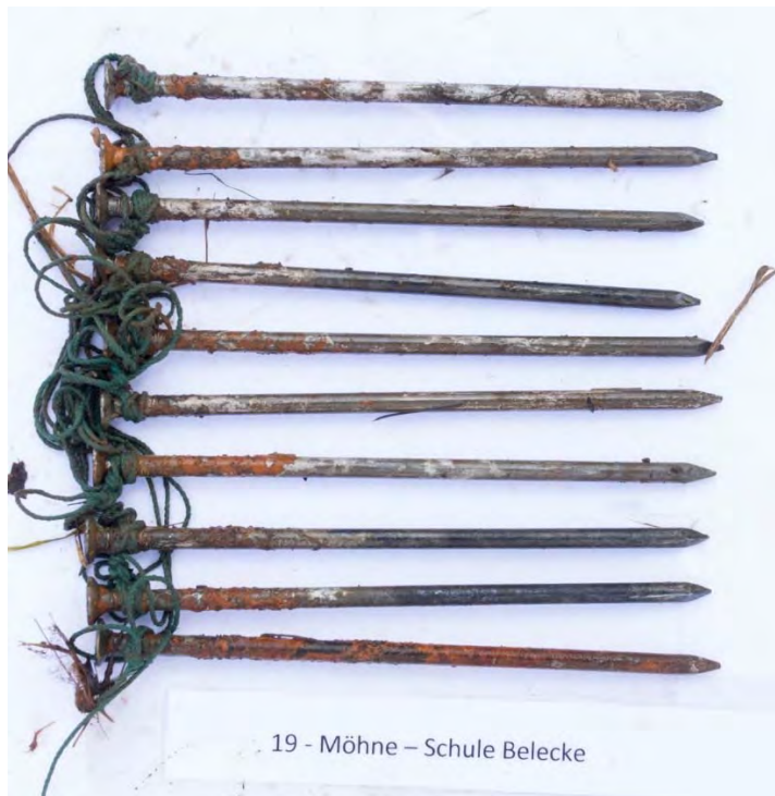
Abb. 5.5.2-7: Probestrecke 19, Möhne Schule Belecke: Der unterste Nagel war nicht in den Kies eingeschlagen und ist daher besonders stark verrostet. Bei den anderen reicht der Rost nur zwei bis drei Zentimeter vom Kopf nach unten; nur die oberen Partien der Kiesbank waren also gut durchströmt.
