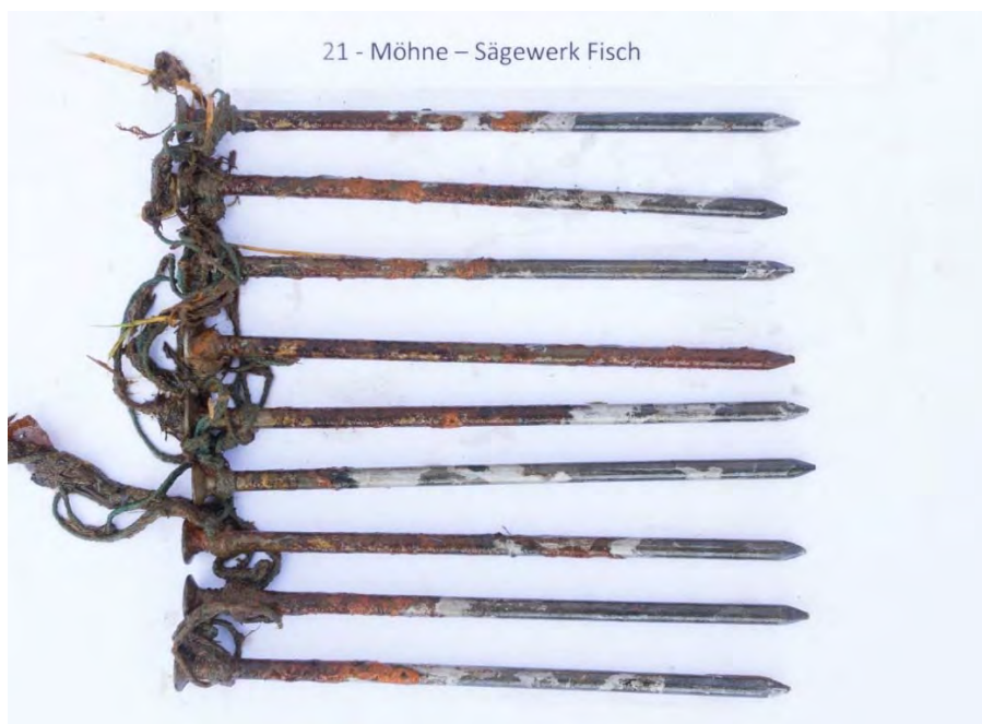
Abb. 5.5.2-8: Probestrecke 21, Möhne Sägewerk Fisch: Ein Nagel fehlt, wahrscheinlich der letzte, nicht in den Kies eingeschlagene „Referenznagel“.
