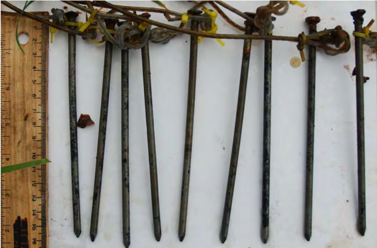
Abb. 4.3.2.2-1: Nägel mit nur sehr geringem Rostansatz nach drei Monaten im Gewässer (aus Land Oberösterreich 2005)
