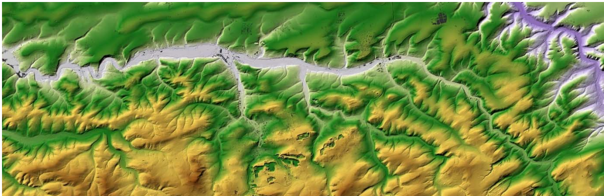
Abb. 3.1-4: Möhne zwischen der Mündung in die Möhnetalsperre (links) und dem Oberlauf bei Brilon-Wülfte, Höhenstufenmodell aus Laserbefliegungen DGM 1 (Quelle: Bezirksregierung Arnsberg): Das im Oberlauf sehr schmale Tal verbreitert sich östlich von Rüthen deutlich. Seine größte Breite erreicht es zwischen Belecke und Allagen, danach wird es wieder enger.
