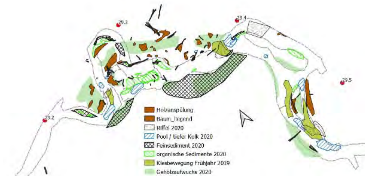
Abb. 5.4-40: Probestrecke MO 11: Strukturkartierung mit Ablagerungen von Feinsedimenten und Gehölzaufwuchs 2019/20
